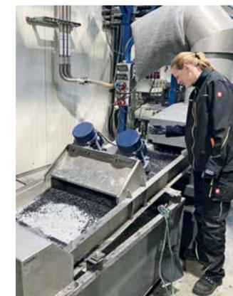
**Kreislauf:** Aus dem Ausschuss entsteht Granulat, das in die Produktion zurückgeführt wird.
