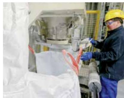
**Abgefüllt:** Als letzter Produktionsschritt wird das Bariumcarbonat „abgesackt“.
