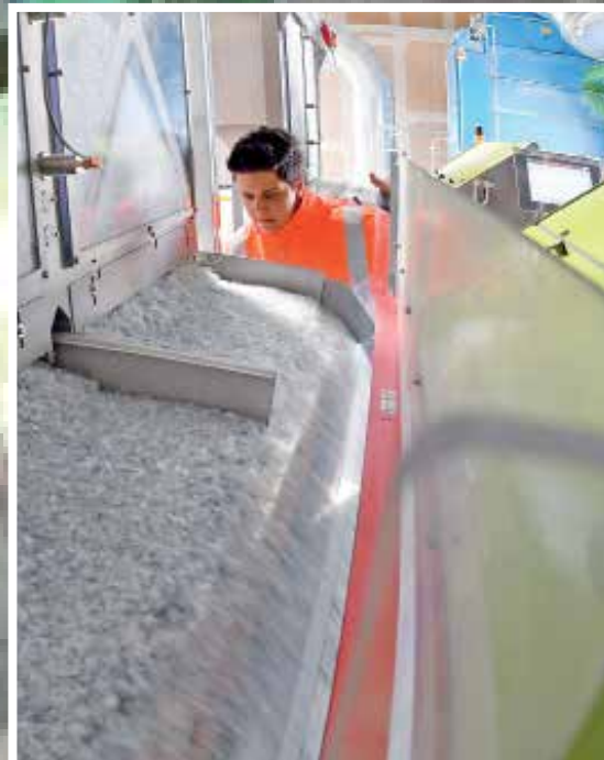
Recycling von PET-Flaschen: In zerkleinerter Form geht der Kunststoff an Unternehmen und wird zu Textilien oder Kleidung verarbeitet.
