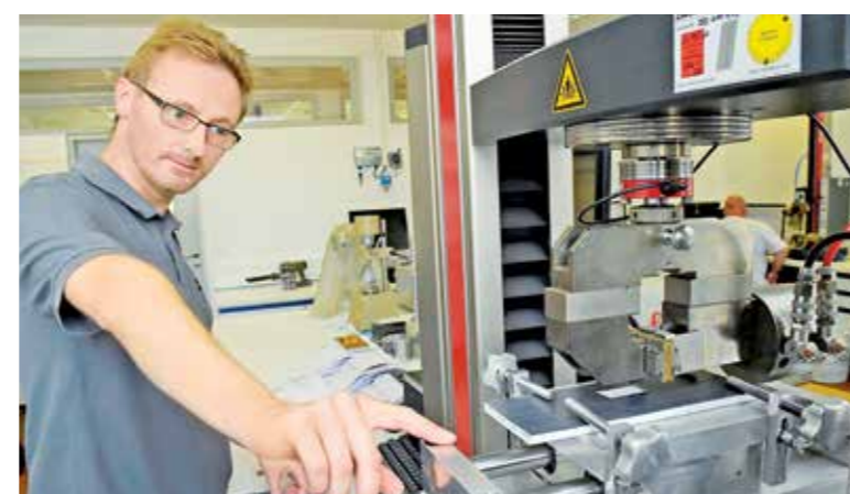
Im Klimaraum: Klebstoffprüfung bei 23 Grad Raumtemperatur.
