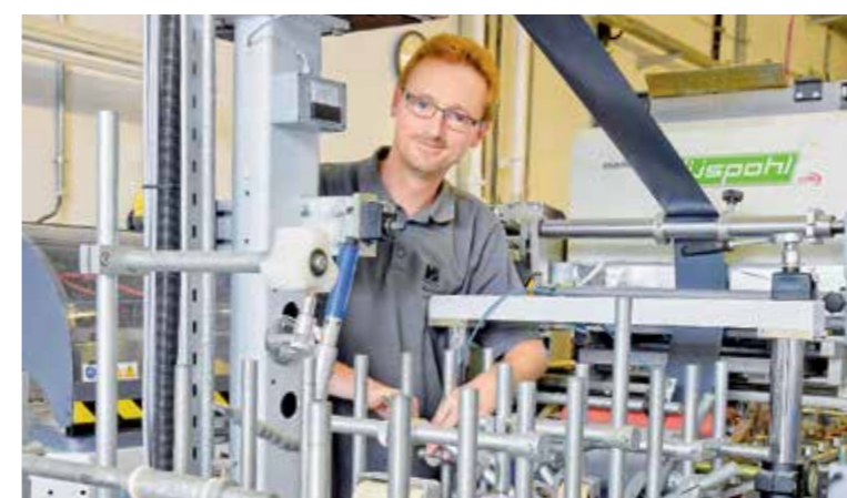
Im Testlabor: An der Kaschiermaschine beschichtet Barthel Fensterprofile.
