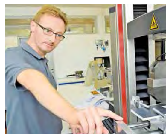
Im Klimaraum: Klebstoffprüfung bei 23 Grad Raumtemperatur.
