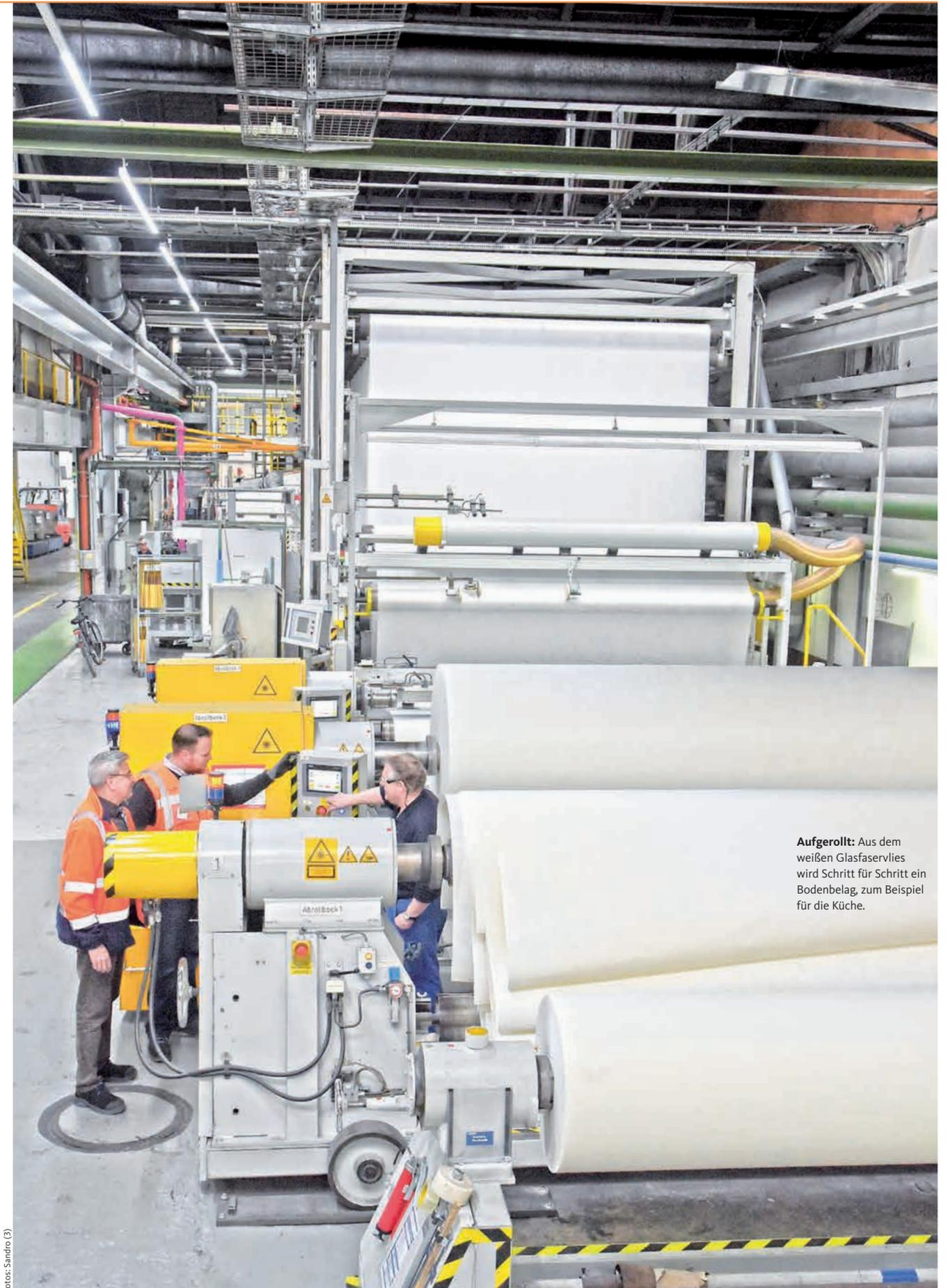
**Aufgerollt:** Aus dem weißen Glasfaservlies wird Schritt für Schritt ein Bodenbelag, zum Beispiel für die Küche.
