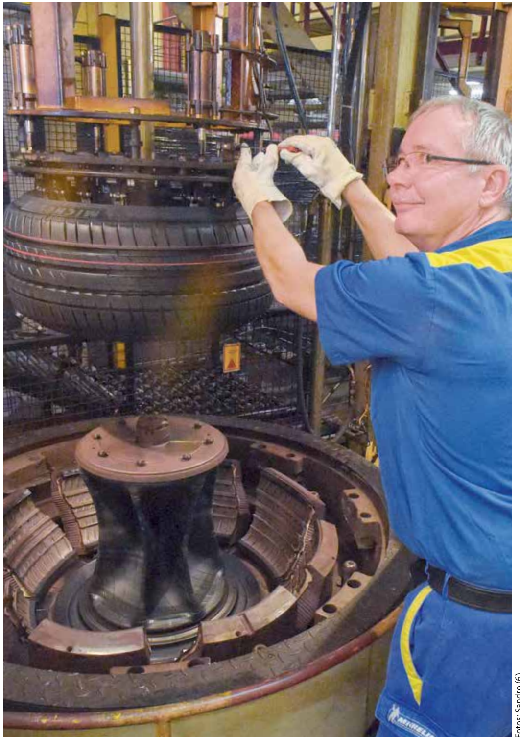
An der Vulkanisationspresse: Der Signalgeber muss eingestellt werden.
